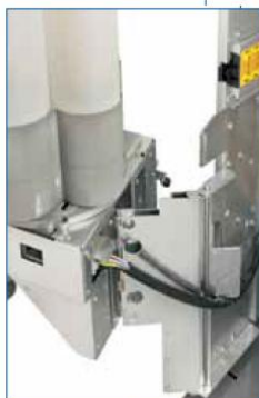
Fácil acesso ao interior, mesmo quando agrupada a outras máquinas, graças à abertura de 180° da torre dos copos, com dobradiça dupla
